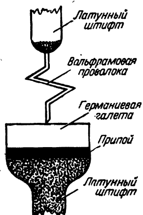
Фиг. 2. 4. Точечноконтактный диод.
