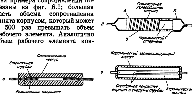
Ф и г. 6. 1. Сравнение рабочего и общего объемов стандартных элементов. а—герметизированное сопротивление 2-го класса.
