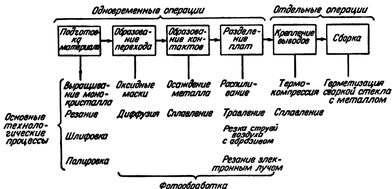
Фиг. 8. 10. Карта последовательности технологических операций при изготовлении твердых схем.
