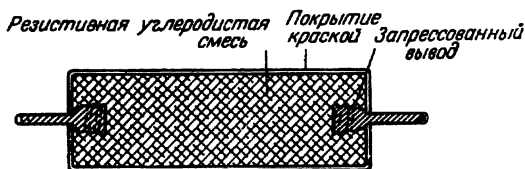
Ф и г. 3. 8. Негерметизированное сопротивление из уголеродистой смеси.
